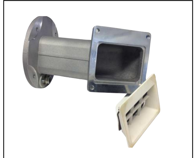
Εικόνα: Οπτικός έλεγχος του αποτροπέα επιστροφής ροής (ντάμπερ)
