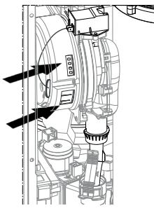
**Βγάλτε τα φίς του ηλεκτροδίου έναυσης, ιονισμού, μετασχηματιστή και του θερμοστάτη ασφαλείας STB.**
