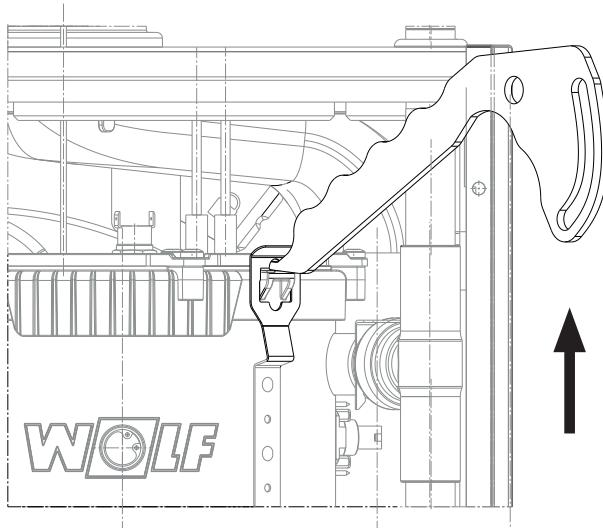
Βάλτε το φίς των ηλεκτροδίων έναυσης, επιτήρησης, μετασχηματιστή και του θερμοστάτη ασφαλείας STB.
