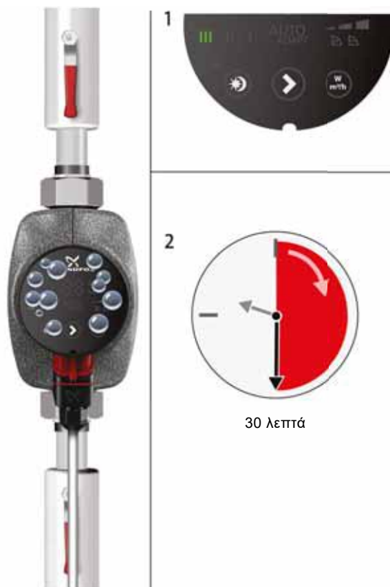
Σχ. 8 Εξαέρωση του κυκλοφορητή
