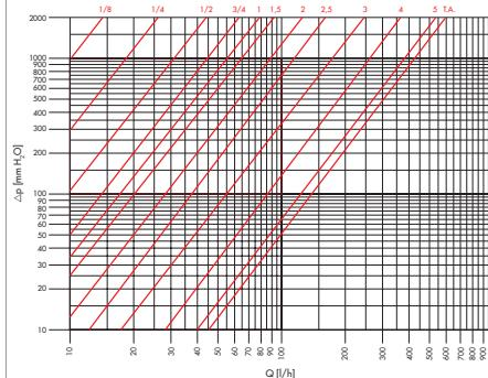
Curve relative ai diversi giri di pre-regolazione sul detentore e alla apertura nominale della relativa valvola (con capillare e testa termostatica a distanza) corrispondente a  $\Delta t = 2^\circ\text{C}$
