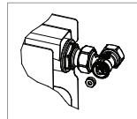
In caso di manutenzione è possibile sostituire l'anello O-ring dell'asta svitando la calottina del vitone mediante l'ausilio di una chiave esagonale da 11 mm. Questa operazione può essere effettuata anche ad impianto funzionante.
