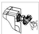
Nel caso di valvole con protezione da cantiere, dopo aver svitato in senso antiorario il cappuccio rosso, sganciare la protezione da cantiere facendo leva sulla base mediante l'ausilio di un cacciavite.
